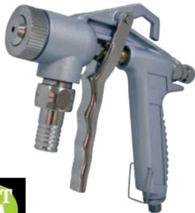
Boquilla especial materiales densos de 4, 6 y 8 mm. Boquilla y punta de aguja 100% inox. Regulador de producto. entrada con tuerca -espiga diam 18. Gatillo "4 dedos" con sistema de bloque antifátiga.
