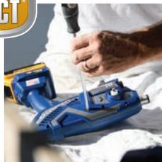
1. Retire la cubierta con un destornillador.
