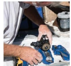
3. Instale la bomba nueva en el pulverizador.
